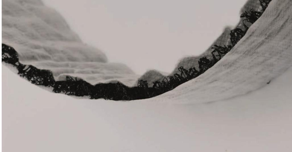
Géocomposite de drainage à structure tridimensionnelle à très haute capacité drainante.
