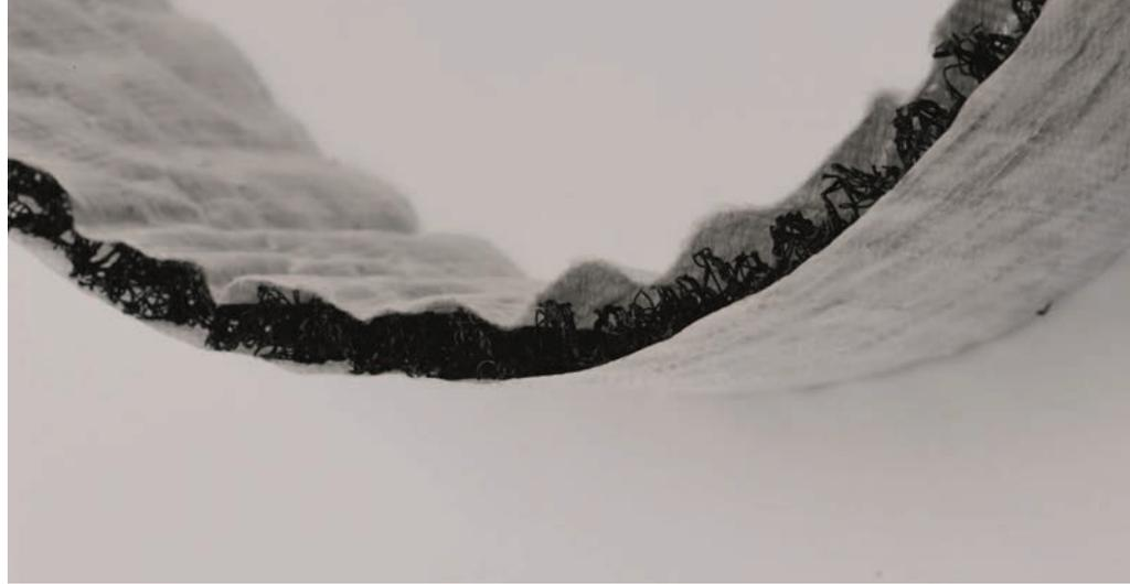
Drainage-Geokomposit mit dreidimensionaler Struktur mit sehr hoher Drainagekapazität.
