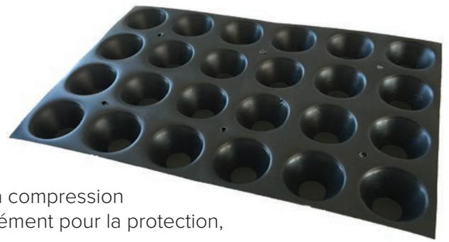
Élément de drainage et de rétention d'eau (réservoir) résistant à la compression pour toitures végétalisées et surfaces praticables-carrossables. Élément pour la protection, la séparation, le drainage et la rétention de: 9 l/m<sup>2</sup>.
