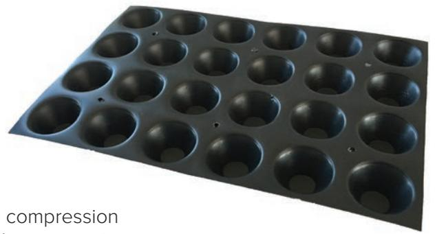
Élément de drainage et de rétention d'eau (réservoir) résistant à la compression pour toitures végétalisées et surfaces praticables-carrossables. Élément pour la protection, la séparation, le drainage et la rétention de 9 et 24 litres d'eau par m<sup>2</sup>.
